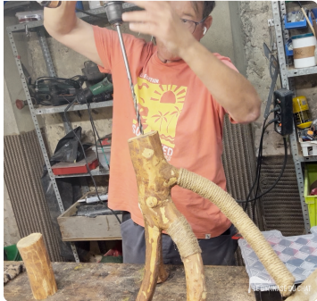
Ici une branche de cerisier, percée pour recevoir une tige filletée
