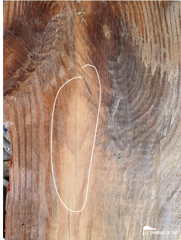
Remplissage d'une fissure avec de la pâte à bois maison
